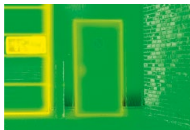
Deutlich geringerer Energieverlust dank thermisch getrennter Tür
