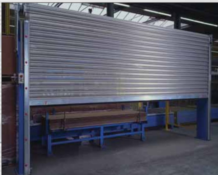
Sicherung von Produktionsmaschinen.
