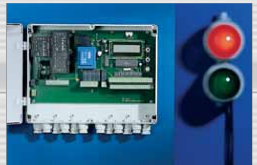
Gegenverkehrssteuerung MS 410 Microprozessor-Steuerung mit Absolutgeber-Auswertung (Einstellung, Wartung, Fehlerdiagnose). Programmierung über 3-Tasten-Navigation am LCD-Monitor mit mehrsprachiger Klartextanzeige. (Einsatz: z.B. Tiefgaragen mit Fahrbahnregelung und Rollgitter mit Einzugsicherung.)
